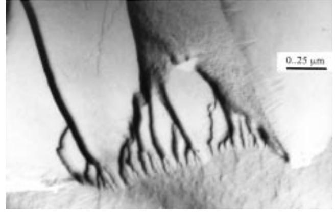
**Fig. 10.** Phase lyotrope ; rivières de dislocations vis et joint de torsion.
